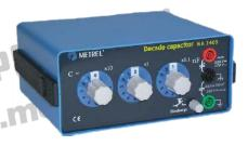
设置值在十进制拨码器上直接可见。MA2405 十进 制标准电容器使用高质量的聚丙烯电容器, 可提供的 5%的精度。
